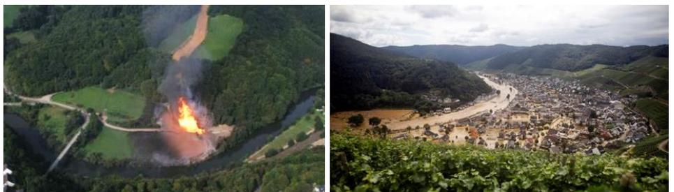
Es gilt dringender Handlungsbedarf aufgrund der mit fortschreitendem Klimawandel zunehmenden Gefahren. Die Gefahrenszenarien resultieren oft in schwersten Schadensausmaßen mit einem vollständigen Abriss der Gasleitung (Abbildung links).
